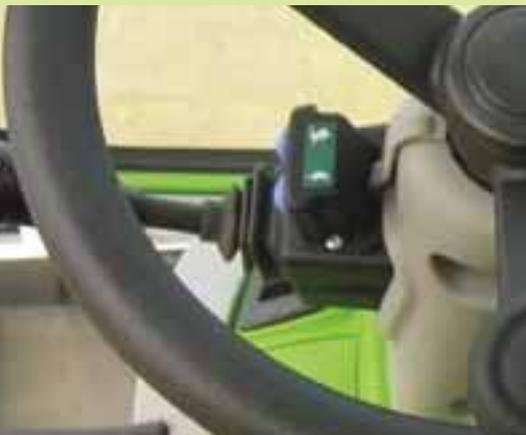
Der Joystick gestattet dem Fahrer zur Steigerung der Arbeitspräzision die proportionale Betätigung.
