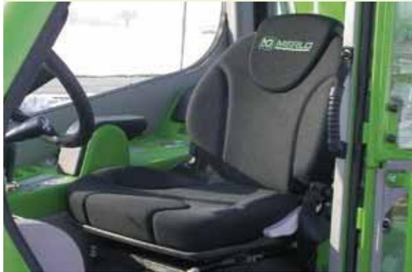
Optimal an die Bedürfnisse der Benutzer angepasst, bietet der neue Fahrersitz von Merlo maximalen Komfort dank seiner umfangreichen Verstellmöglichkeiten. Für den Maschineneinsatz unter besonders schweren Arbeitsbedingungen ist der Fahrersitz optional mit pneumatischer Federung erhältlich: hierdurch wird eine wirksamere Dämpfung der Stöße bei Geländeunebenheiten erzielt.
